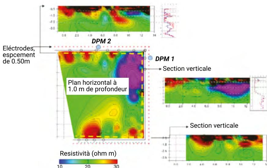
A côté, une séquence de relevés ERT pendant le traitement. En particulier, la variation de la résistivité du sol représente l'amélioration obtenue grâce aux injections de résine réalisées de manière ciblée et sur plusieurs niveaux de profondeur.
